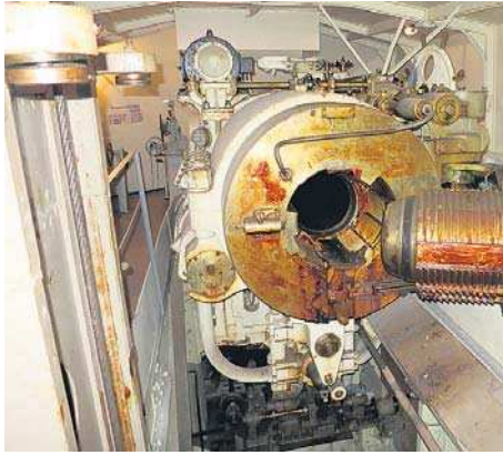
Obuhovin putken alkupää, sulkulaitteisto lukko avattuna.
