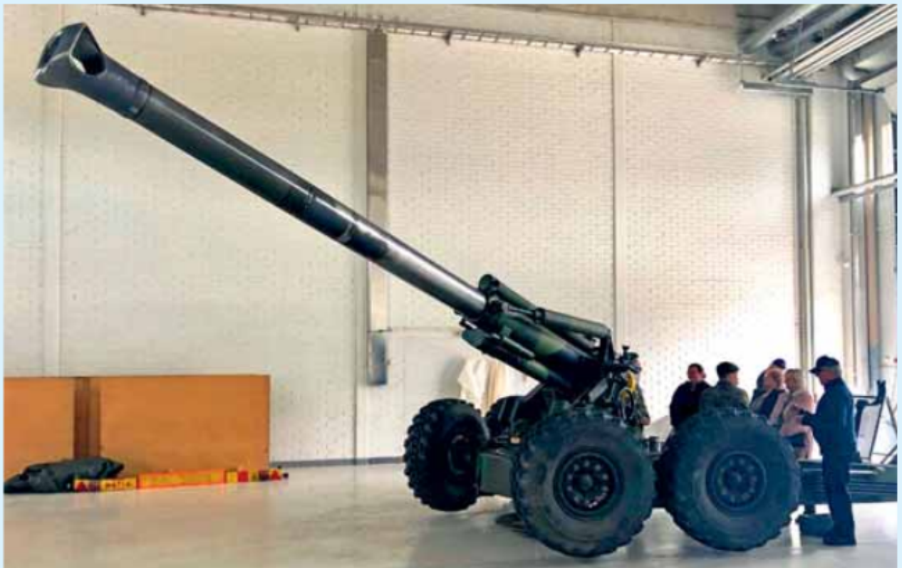
Tätä asetta ei varuskunta-alueen kuvauskielto koskenut: Raskas kanuuna 155 K 83–97, valmistaja Vammassuomi, kaliiberi 155 mm, kantama 29 km, 6 laukausta/min, paino 10,5 tn, ammuksen paino 43 kg.
